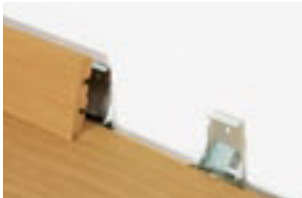
Clips pour fixation des plinthes PGCLIPSKME95 – modern plank 9 mm PGCLIPSKME7080 – domestic elegance Pour les plinthes PGSK(-) uniquement, y compris les variantes à peindre / blanches. Système de clips facile à utiliser où aucun clou ni vis ne sont visibles. Un kit d'installation couvre 20 mètres de plinthes.
