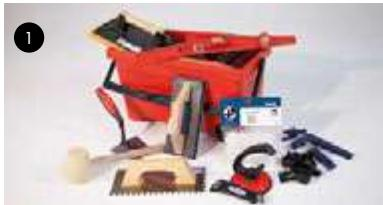
**1-** La pose de céramique doit être réalisée par une personne qualifiée et expérimentée munie des outils adéquats : taloches crantées, croisillons, maillets en caoutchouc, ventouses pour la pose et taloches en caoutchouc, éponges et bacs à joints. Contrôler au préalable les informations contenues dans les emballages et respecter scrupuleusement les recommandations du fabricant.
