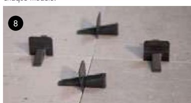
**8-** Les joints doivent mesurer au moins 1 mm pour les revêtements de sol intérieurs et 5 mm pour les extérieurs. Pour les poses à joints décalés, effectuer la pose aux ¾ du carreau. Il est recommandé d'utiliser des croisillons autonivelants.
