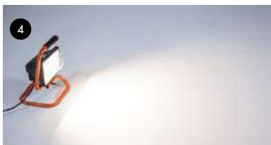
**4-** L'éclairage du lieu de travail doit être suffisamment puissant pour permettre de détecter facilement tout défaut de pose, en particulier les balèvres entre carreaux. Il est recommandé de travailler avec des projecteurs électriques et un niveau d'éclairage supérieur à la normale.
