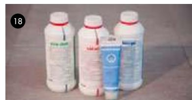
18- Lors du nettoyage du chantier, utiliser des produits adaptés à la résistance chimique des carreaux. Éviter d'utiliser les détergents solides contenant des particules abrasives, tout comme les agents de nettoyage à base d'acide fluorhydrique (HF). Cet acide attaque l'émail et endommage la céramique de façon irréversible.
