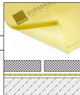
**Bande d'étanchéité**, agréée ETAG, pour système d'étanchéité DURABASE ET-S
