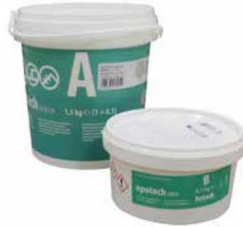
**epotech aqua** epotech aqua, nouvelle ligne de mortier joint à base de résine époxy destiné au jointoiment de carreaux céramiques. Joint bicomposant exempt de solvants organiques, se caractérise par son étanchéité, résistance aux attaques chimiques et prestations mécaniques tout en offrant une application facile. Particulièrement recommandé pour les applications sur mosaïques et céramique avec relief.
