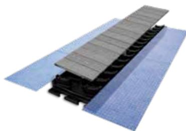
Système de drainage pour piscines et terrasses avec revêtement supérieur en céramique. Il s'agit d'un nouveau système de canal de récupération des eaux préparé pour recevoir le carrelage de PORCELANOSA Grupo et permettre à l'eau de s'écouler à travers les joints entre les carreaux. Compatible avec tout système d'étanchéité extérieure, il remplace les traditionnelles grilles en métal ou en plastique qui affectent tant le design des sols extérieurs.
