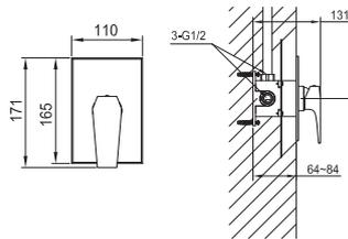
Tous nos modèles encastrés sont équipés d'un boîtier d'encastrement permettant une installation simple et rapide
