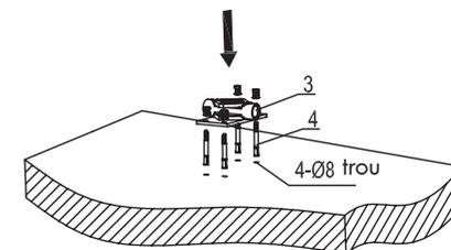
Fig. A - Positionner sur la dalle béton
