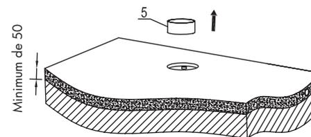
Fig. D - Retirer les protections
