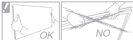
Manipular el espejo desde el lateral, sujetando la luna al mismo tiempo. Manipulando o espelho do lado, que prende a Lua ao mesmo tempo. Manipuler le miroir à partir du côté, de maintenir de la lune ensemble. Manipulate the mirror from the side, holding the mirror together. Manipulieren Sie den Spiegel von der Seite und halten dabei das glas fest. Manipulowanie lustro z boku, trzymając księzcę w tym samym czasie.
