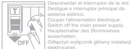
Desconectar el interruptor de la red. Desligue o interruptor principal do sistema eléctrico. Couper l'alimentation électrique. Switch off the main power supply. Hauptschalter des Stromnetzes ausschalten. Odłączyć wylącznik główny instalacji elektrycznej.
