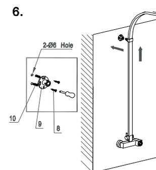
Dévisser les 2 vis de la barre, assembler le mitigeur à la barre, resserrer les vis après montage
