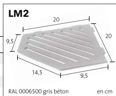
**TI-SHELF LINE Tablette d'angle avec rebords et crochets**
