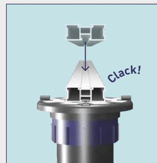
Il suffit de placer la lambourde sur le clip et d'appuyer dessus pour la mettre en place.
