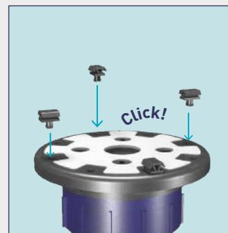
Le clip à lambourde s'insère dans la tête dans le but de fixer le plot à la lambourde en aluminium.
