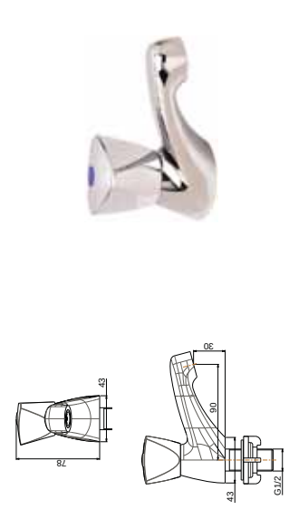
ROBINET LAVE-MAINS EAU FROIDE 110E Soupape ordinaire Brise-jet Livré sans bonde (p.112) 110E 33,10 €
