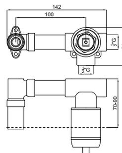
**1A** Partie externe mitigeur lavabo encastré avec poignée striée et bec rond. À 3 bars de pression 5,68 l/min.
