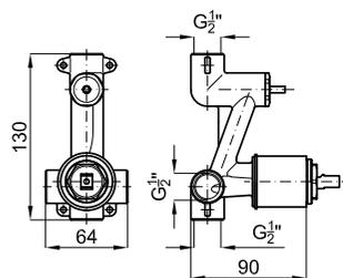
PROJECT LINE - Corps interne mitigeur encastré bain douche, avec cartouche céramique de Ø35 mm. Inverseur automatique et connexion de 1/2", débit à 3 bars de pression baignoire 20 l/min et douche 18 l/min,
