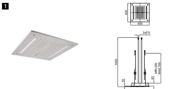
**1** SQUARE Ciel de pluie encastré au plafond 40cm. Fonctions pluie, cascade et chromothérapie. Inclus télécommande pour le contrôle de la chromothérapie. Protection IP67. Tension d'alimentation 110-230V. Robinetterie non incluse; 2 voies sont nécessaires pour son fonctionnement. Débit minimum nécessaire de 16l/min et 21l/min pour la cascade. SQUARE
