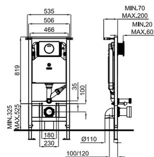
1 I-COMFORT LINE Plaque de commande à un bouton poussoir et système de décharge IR, pour bâti-support avec système d'extraction d'odeurs.
