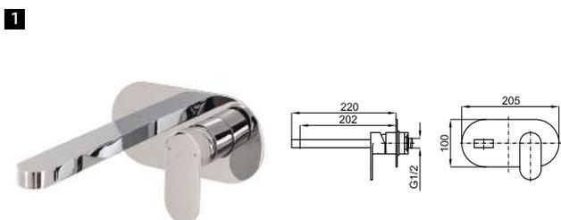
**1** Partie externe mitigeur lavabo encastré avec cartouche céramique de 35mm. Sans vidage. Le débit à 3 bars est de 5l/min (eau mitigée). Possibilité d'installation verticale ou horizontale
