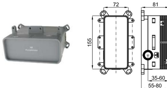
1 Partie externe mitigeur lavabo encastré avec cartouche céramique de 35mm. Sans vidage. Le débit à 3 bars est de 5l/min (eau mitigée). Possibilité d'installation verticale ou horizontale
