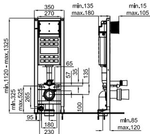
Bati support autoportant pour cuvette suspendue avec pré installation de l'abattant électronique. Installation sur mur léger. Inclus kit de fixation et connexions avec l'abattant/WC
