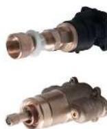
**1** SMART BOX SLIM- Corps encastré d'installation rapide universelle pour thermostatique à 1, 2 ou 3 sorties. Avec cartouche thermostatique en cire incorporée et connexions 1/2". 3 bars de pression pour une sortie: 22,4 l/min. et pour l'autre deux: 19,5 l/min.
