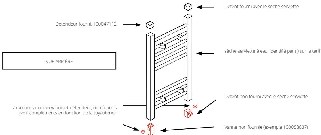
Le detent et les fixations murales sont inclus avec les sèche-serviettes à eau. Le raccords, la vanne monotube verticale ou horizontale sont toujours en chromé, tout comme le bouchon 1/2" du sèche-serviettes. Les codes de la vanne et du détendeur montrés ici sont ceux de la finition chromée.
