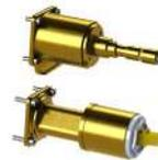
1 SMART BOX - Corps encastré d'installation rapide universelle pour mitigeur à 2 ou 3 sorties. Avec cartouche céramique de Ø35mm et connexions 1/2". Le débit à 3 bars de pression est de 20,1 l/min aux trois sorties. 2 silencieux et 2 bouchons 1/2" inclus. **100124167**
