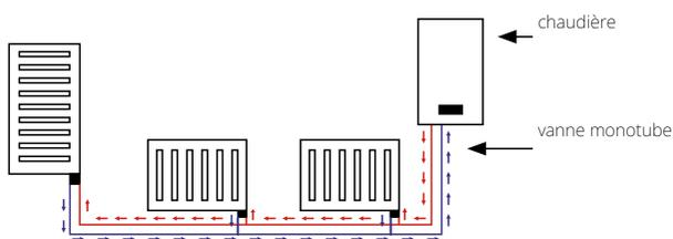
B. - Schéma d'installation bitube
