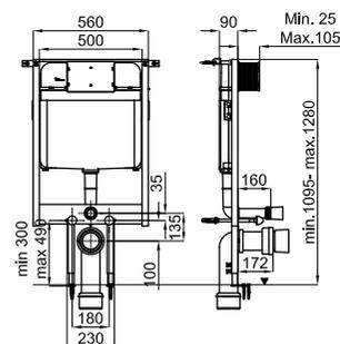
**1A** Bâti avec double chasse encastrée, pour WC suspendu (pour mur en plâtre) incluent le kit de fixations. ECO
