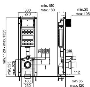
Châssis WC suspendu avec chasse d'eau, autoportant, de 35 cm de largeur. Kit de fixation et tubes de connexion à WC inclus.
