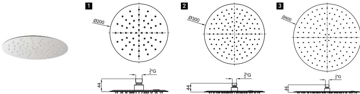
**1** ROUND. Ciel de pluie de 20cm., avec articulation. Comprend valve de sécurité. Le débit à 3 bars est de 9 l/min.
