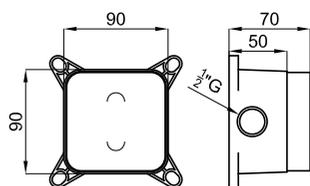
SMART BOX BATH - Corps encastré installation rapide universelle pour robinetteries installation au sol avec connections 1/2".
