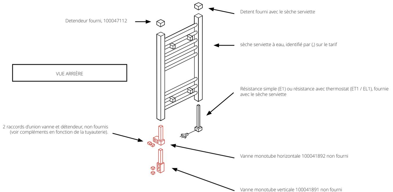
Les codes indiqués des vannes et des raccords sont valables pour la finition chrome. Pour pouvoir établir un devis des raccords dans d'autres finitions, il suffit de tenir compte des indications précédentes pour les sèche serviettes à eau.
