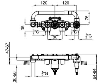
**1** Partie externe thermostatique avec prise d'eau et support magnétique. Inclue douchette avec flexible
