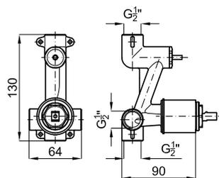
PROJECT LINE - Corps interne mitigeur encastré bain douche, avec cartouche céramique de Ø35 mm. Inverseur automatique et connection de 1/2", débit à 3 bars de pression baignoire 20 l/min et douche 18 l/min, **100107958**
