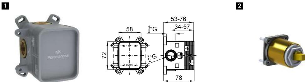
**1** SMART BOX - Corps encastré d'installation rapide universelle pour mitigeur à 1 sortie. Avec cartouche céramique de Ø35mm et connexions 1/2". Le débit à 3 bars de pression est de 22,1 l/min. 2 silencieux et un bouchon 1/2 inclus. **100124166**
