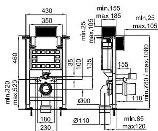
Châssis WC suspendu avec chasse d'eau, de hauteur réduite, avec possibilité d'actionnement supérieur ou frontal. Kit de fixation et tubes de connexion à WC inclus.
