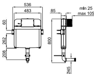
Réservoir encastré WC indépendant. (pour mur en brique). Inclut le kit de fixations au mur et tubes de connection à la cuvette.
