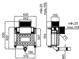
Réservoir encastré pour cuvette indépendante, hauteur réduite. Inclus kit de fixation et connexions pour le WC
