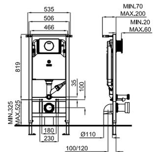
1 I-COMFORT LINE Plaque de commande à un bouton poussoir et système de décharge IR, pour bâti-support avec système d'extraction d'odeurs.
