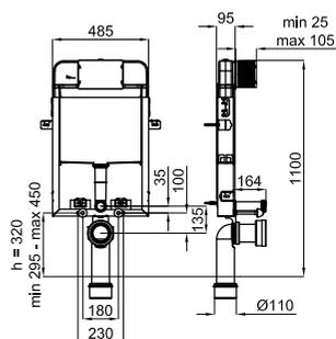
Réservoir à encastrer pour cuvette suspendue. Inclut le kit de fixations au mur et tubes de connection à la cuvette.
