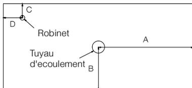
Indiquer les dimensions et le diamètre du tuyau d'écoulement et du robinet en millimètres. La société n'est pas responsable de la définition incorrecte des mesures: aucun retour n'est accepté pour cette raison.
