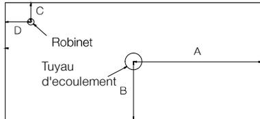
Indiquer les dimensions et le diamètre du tuyau d'écoulement et du robinet en millimètres.
